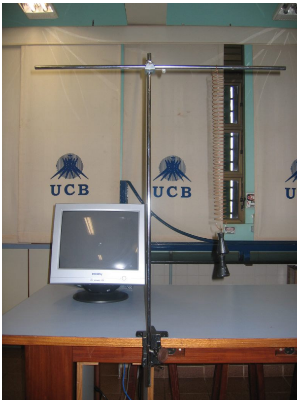
Figura 8: Sistema massa-mola, para o estudo das características do MHS.
