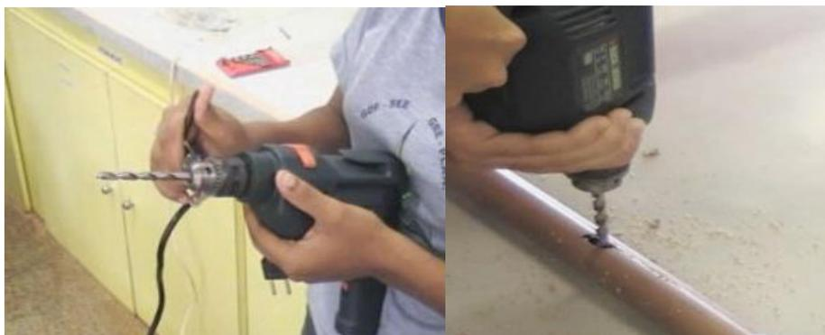
Figura 9 (esquerda) e 10(direita): ajustando a broca e perfurando o cano respectivamente.
