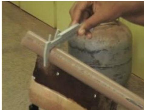
Figura 8: utilizando o paquímetro.
