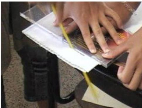
Figura 3: cegueta utilizada para cortar as placas de PVC.
