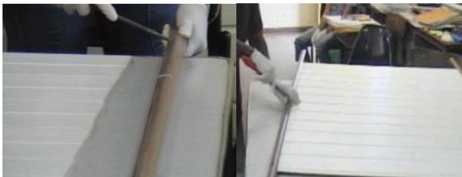
Figura 14 (esquerda) e 15(direita): utilizando a grossa e a lima.
