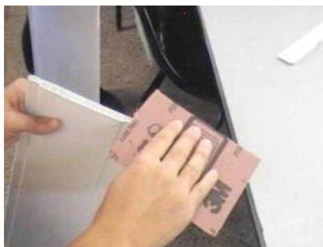
Figura 4: lixa para retirar as rebarbas das placas.
