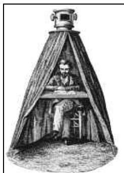
Ilustração 2 - Câmara Escura em forma de tenda utilizada por Kepler 1620. Fonte: Ortensi, 2004
