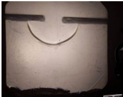
Figura 6 – Difração por fenda na cuba de ondas.
