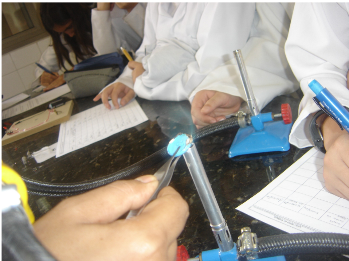
Figura 11 - Aquecimento dos botões na chama do bico de bunsen
