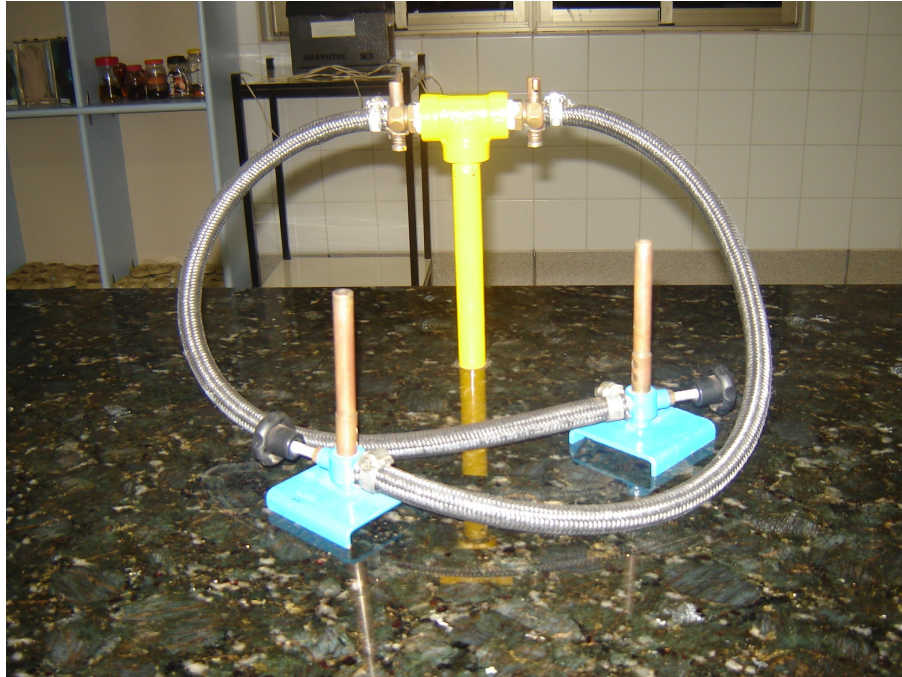
Figura 4 - Tubulação de gás e bico de bunsen
